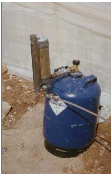
Foto 6. Botella de bromuro de metilo y dosificador.
